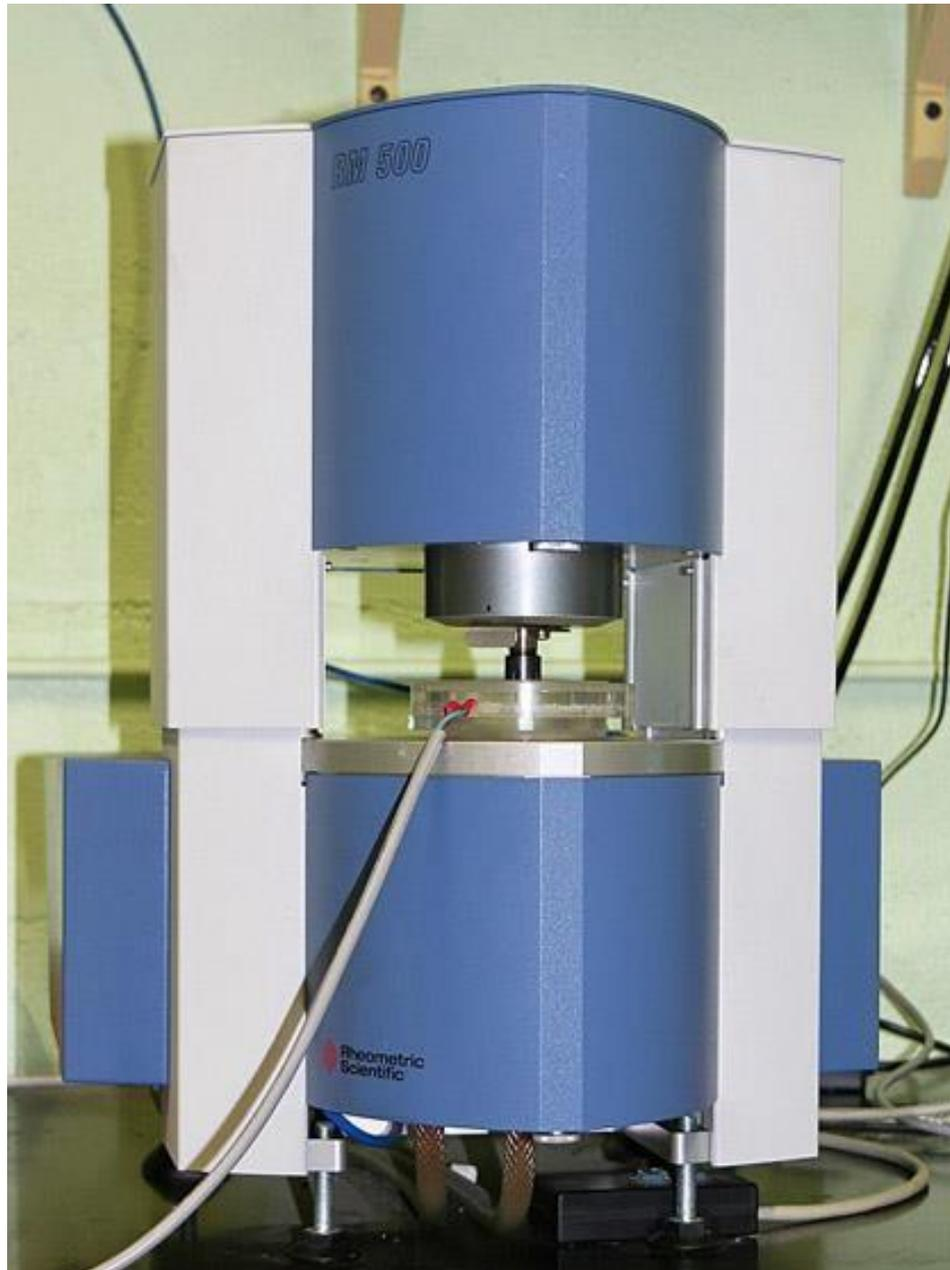
Un récipient cylindrique tourne autour de son axe de rotation. Il contient le liquide visqueux et un cylindre plein. Ce cylindre, mobile sur son axe de rotation, est entraîné par le fluide. Cependant un ressort fixé sur ce cylindre le tient en équilibre.
